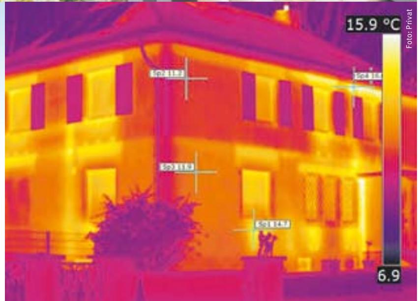
Auf dem abgebildeten Gebäude zeigt sich deutlich, dass weder an der Außenfassade noch an den Dachflächen eine Dämmung vorhanden ist. Hinzu kommen Schwachstellen u.a. bei den Heizkörpern den Fenstern und den Geschossdecken.
